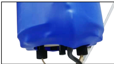
图 6-7 淋洗液发生罐管路连接
