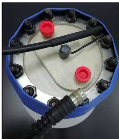
图 6-8 淋洗液发生罐堵头及电缆
